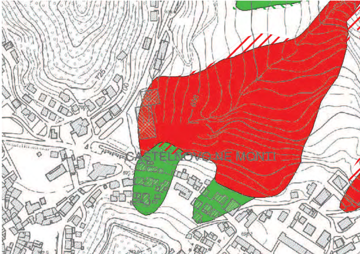
Estratto cartografico PSC - Tav. 5 - Carta del Dissesto Area verde > lotto caratterizzato da frane quiescenti
